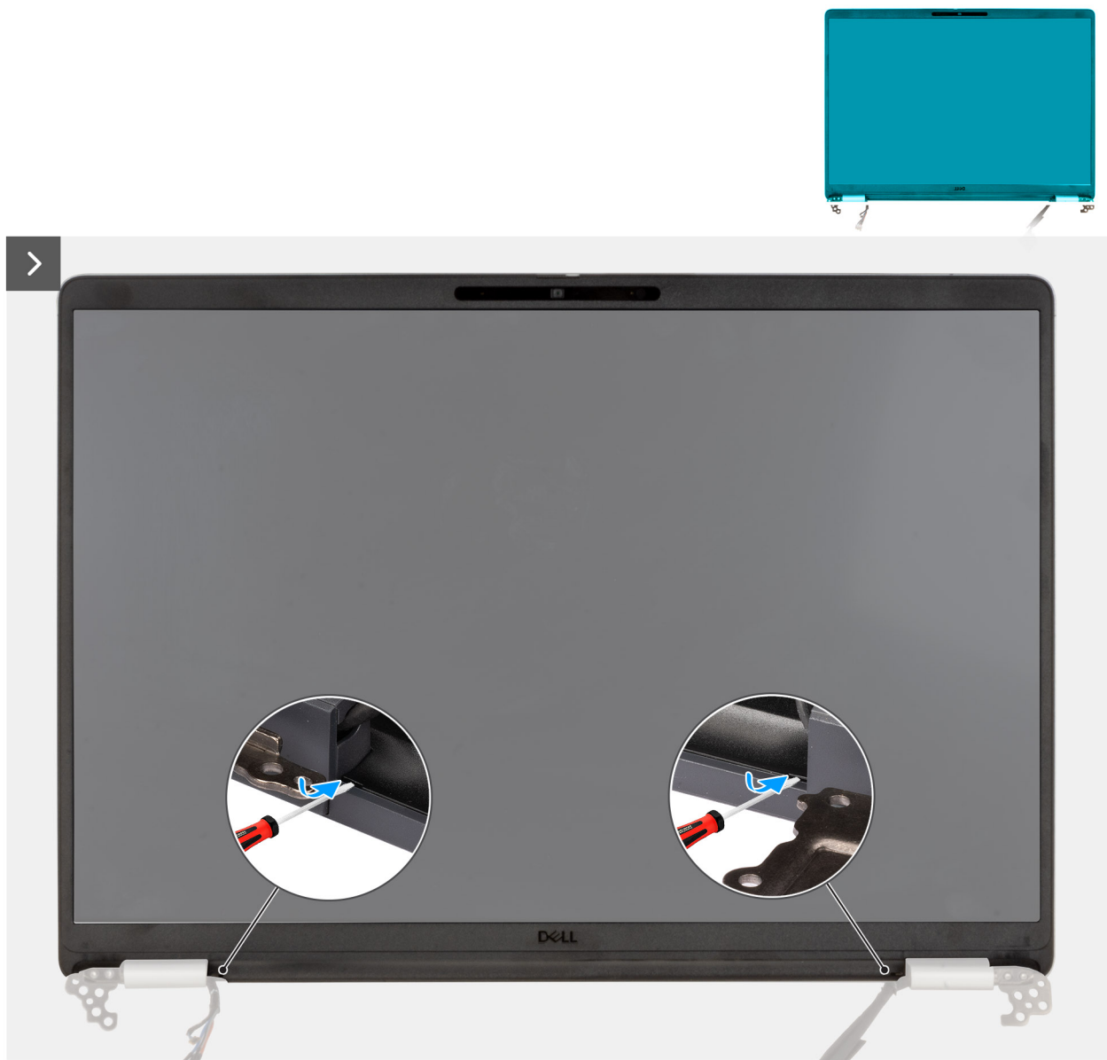
Abbildung 64. Abhebeln der Kunststoffblende
