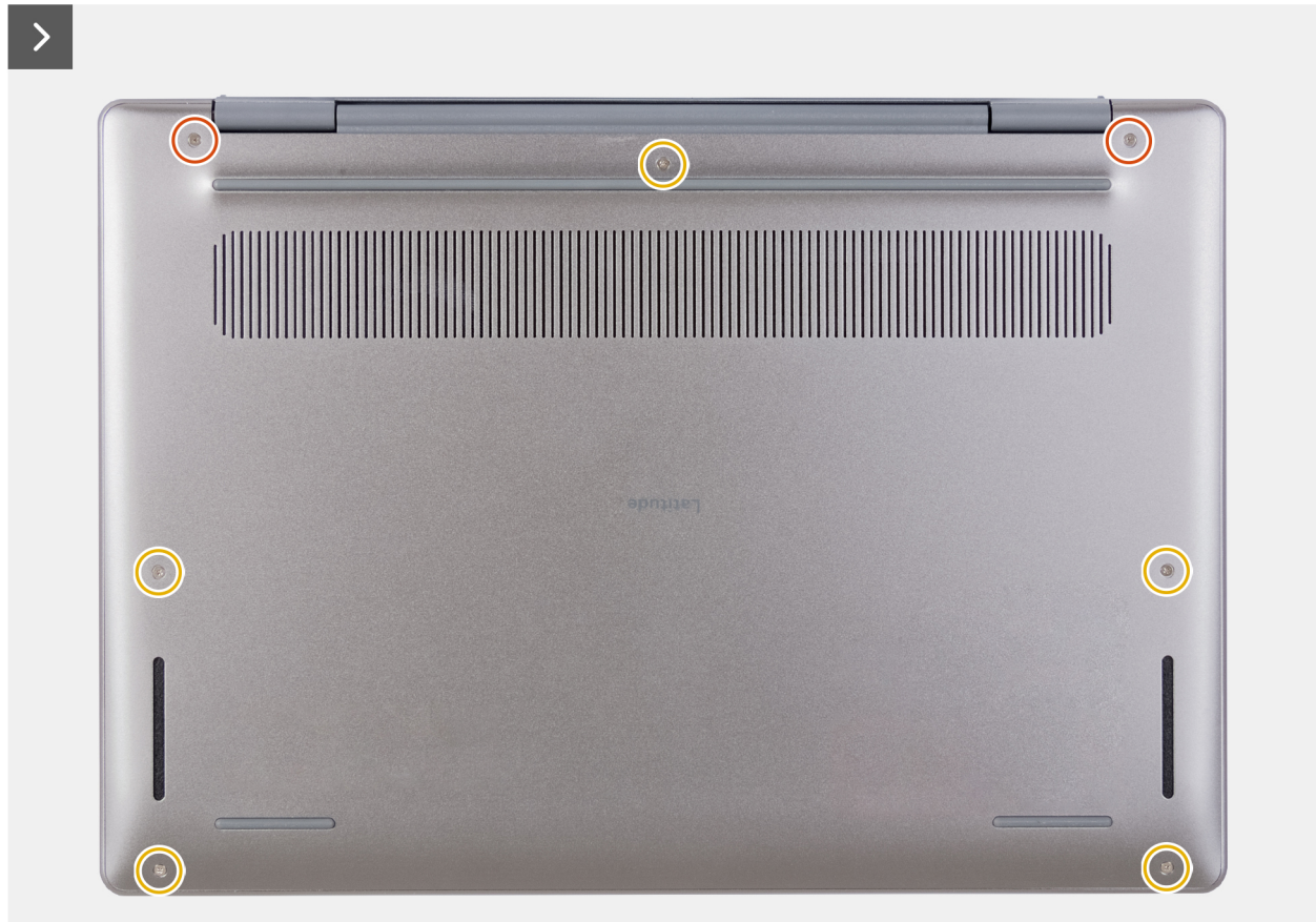
Abbildung 16. Entfernen der Bodenabdeckung
