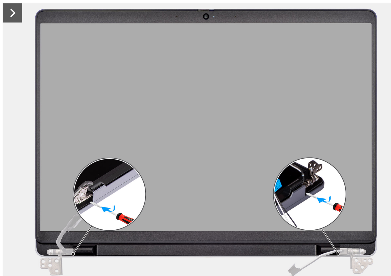
Abbildung 52. Removing the display bezel
