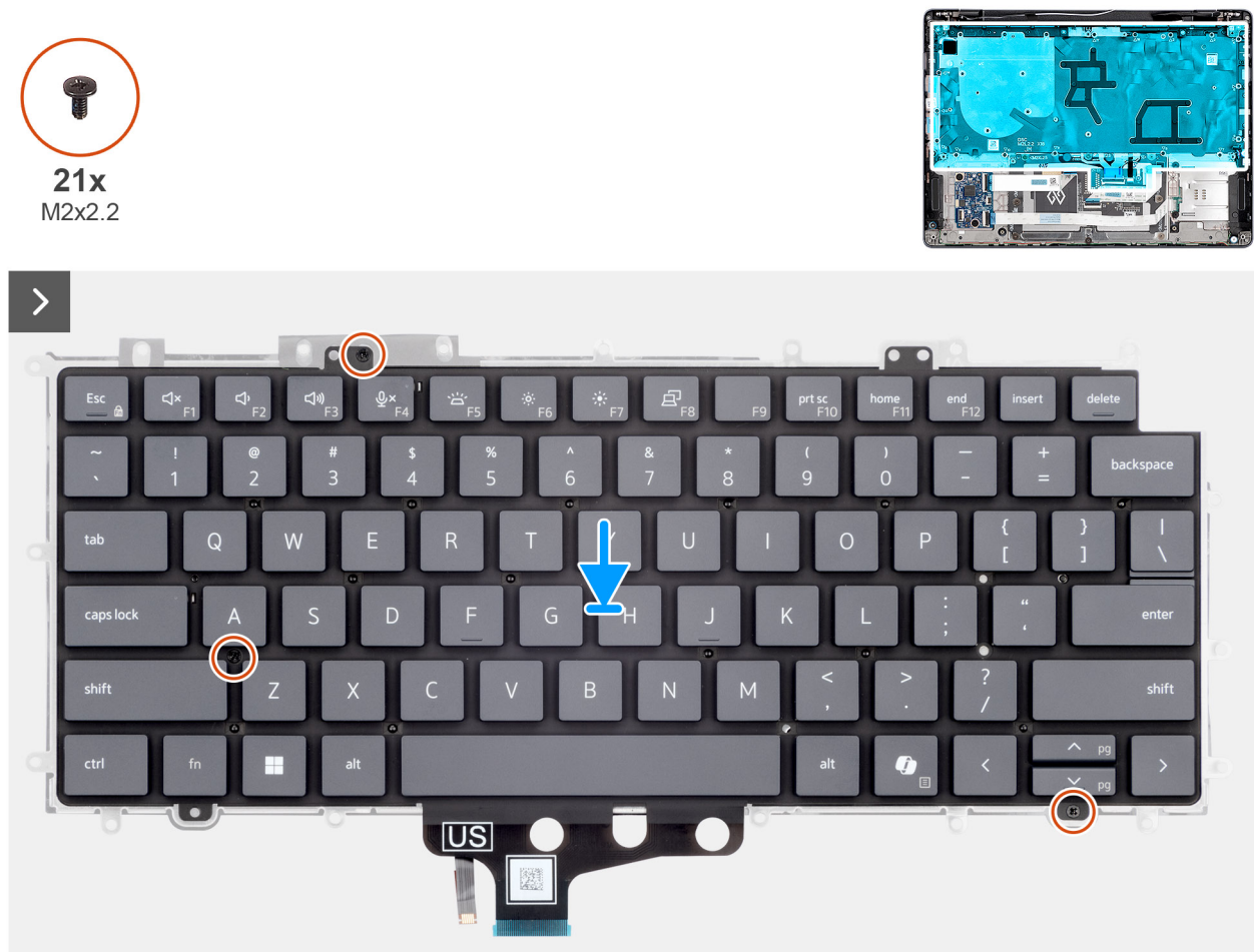
Abbildung 97. Installing the keyboard
