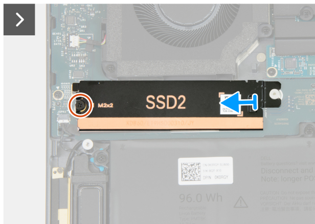
Abbildung 23. Entfernen des M.2 2280-Solid-State-Laufwerks (SSD2)
