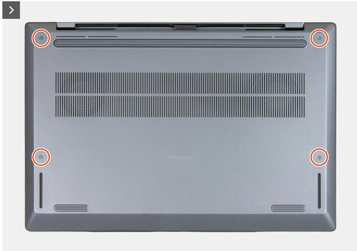
Abbildung 13. Entfernen der Bodenabdeckung
