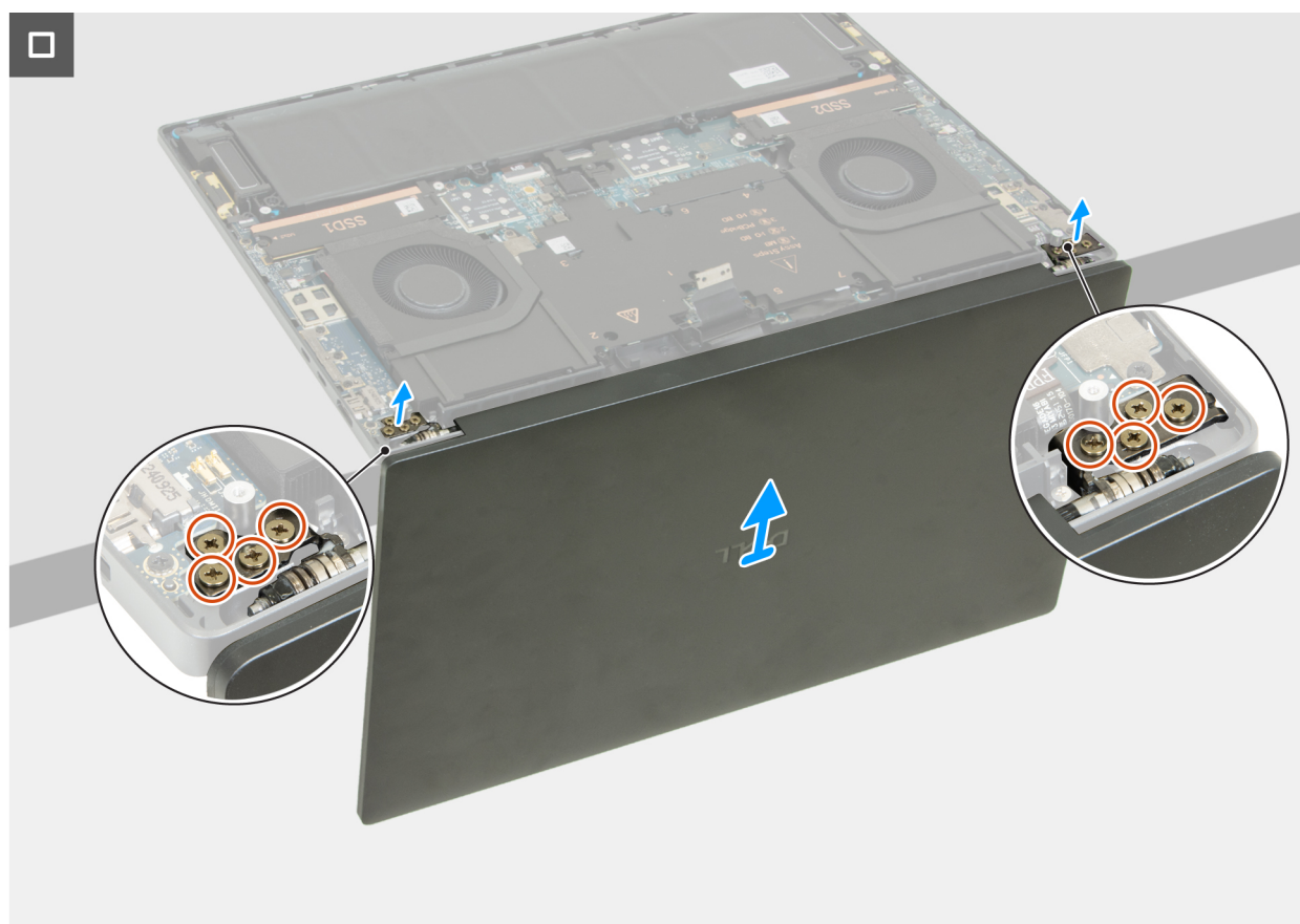
Abbildung 35. Entfernen der Bildschirmbaugruppe
