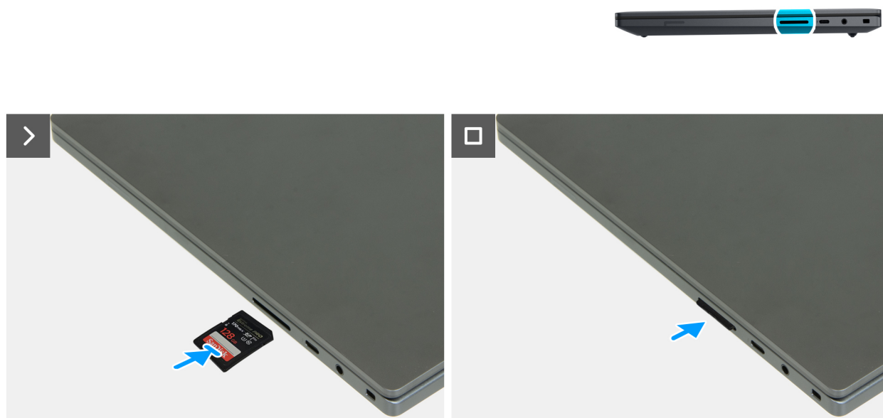
Abbildung 12. Einsetzen der Speicherkarte
