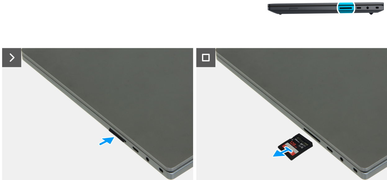
Abbildung 11. Entfernen der Speicherkarte
