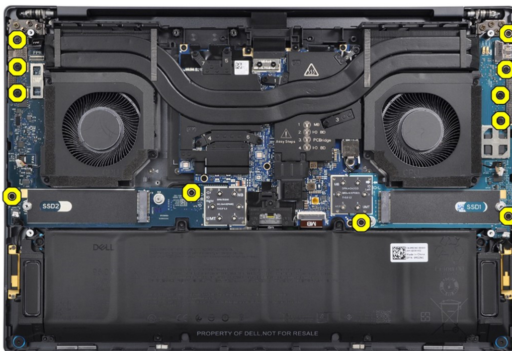
Abbildung 61. Schrauben der I/O-Platinen
