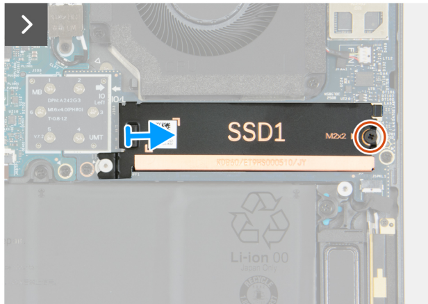
Abbildung 22. Entfernen des M.2 2280-Solid-State-Laufwerks (SSD1)
